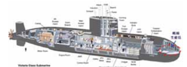
圖 18 加拿大 Victoria 級潛艦艦艙間示意圖
