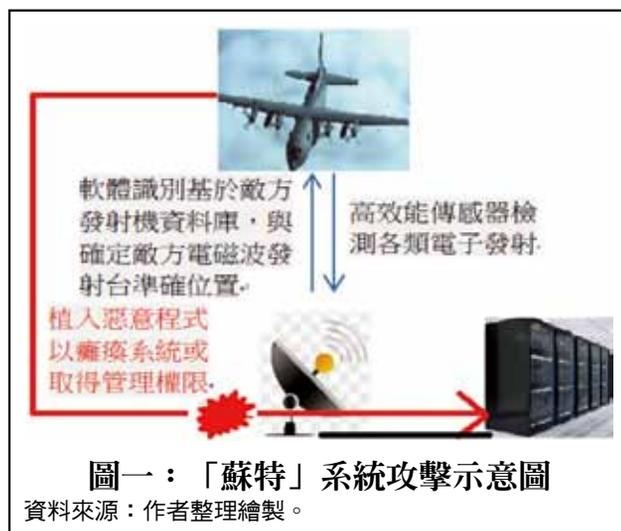
注入假目標主要是利用無人機載傳感器和電子偵察機的偵查結果，經過計算得出注入假目標的相關參數後，再由電子戰飛機向敵方多部雷達同時注入多個假目標。在「蘇特1」中實現的監視能力，是進行網路攻擊的基礎，因此有四項主要步驟：
