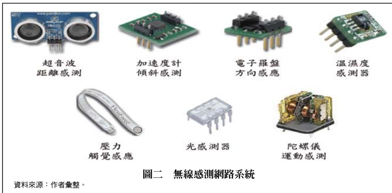
無線通訊技術等，這些技術都是在感知層所需要的關鍵技術。感知層在物聯網中就像是人體的皮膚及五官，針對場景進行感知與監測，用以收集許多不同的資訊。感知層包含了許多具有感知、辨識及通訊能力的設備，例如RFID標籤及讀寫器、二維條碼標籤及讀取器、GPS、影像處理器以及如紅外線、溫度、濕度、光度、亮度、速度、特殊氣體、音量、壓力等各式感測器，設備間利用感測能力對資料加以收集，接著透過彼此相互通訊將不同的資訊進行聚合，最後再將資訊傳至網路層，致使物與物亦或物與人之間產生聯結與互動。而在感知層中則可利用無線射頻技術、無線感測網路及嵌入式技術，執行資料蒐集。
