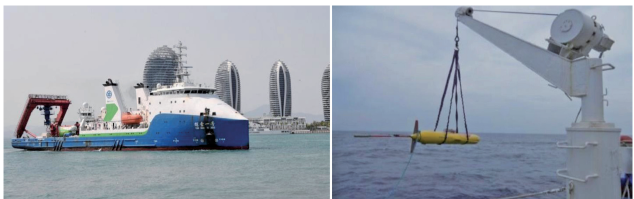
圖六：「探索一號」科考船(如圖左)施放「海翼」水下滑翔機(圖右)
