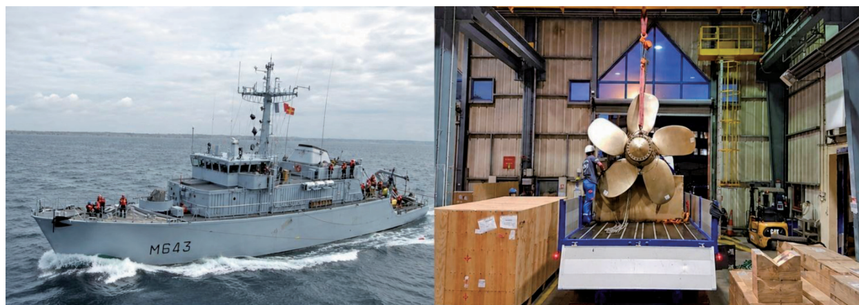
圖四：法國「三方級掃雷艦」-仙女座號(圖左)及「3D列印」製作俥葉(圖右)
