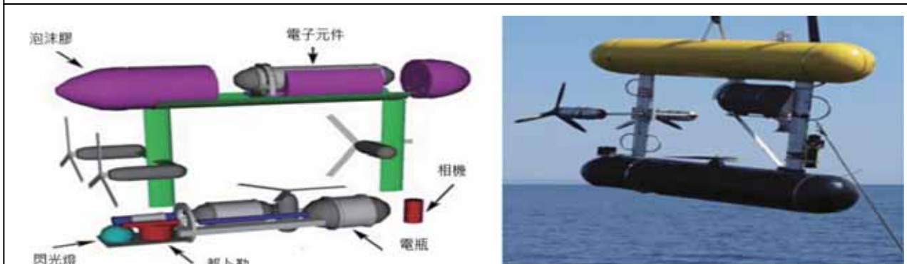
圖五：最初用於海底研究之「自主無人水下載具」
