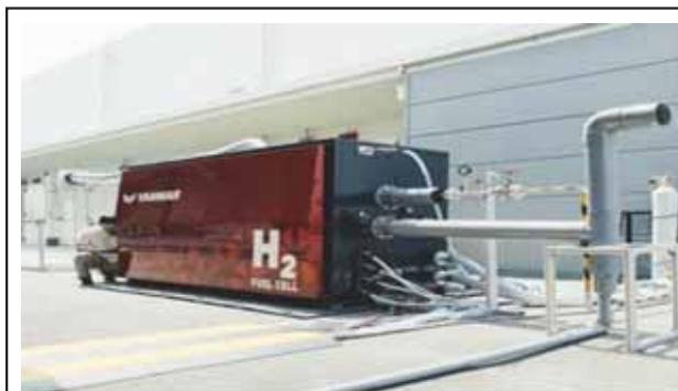
圖九：日本「YANMAR」公司開發之海運氫燃料電池
