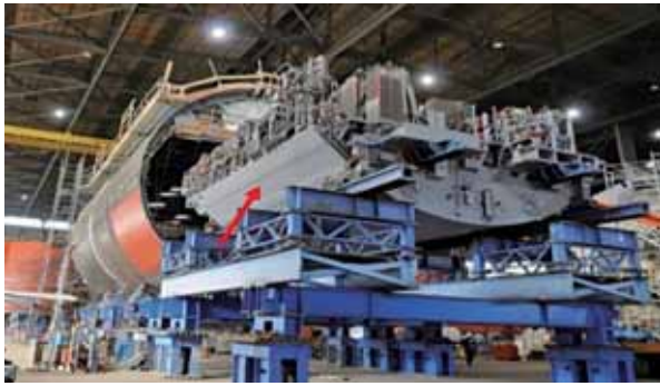
圖二：美軍「維吉尼亞級」潛艦正在安裝減振浮筏裝置
