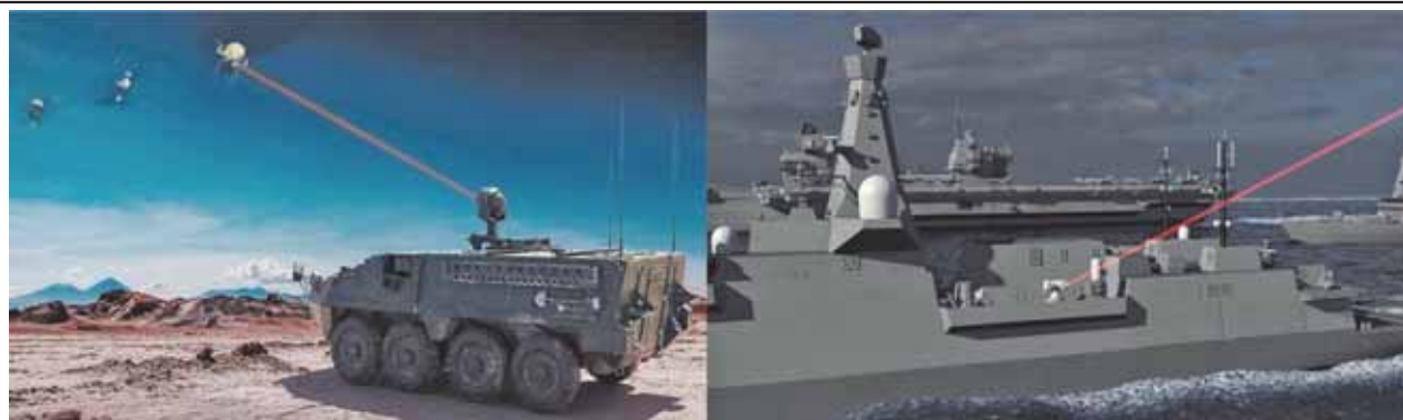
圖七：運用車載型(圖左)或艦載型(圖右)雷射武器反制空中威脅示意圖
