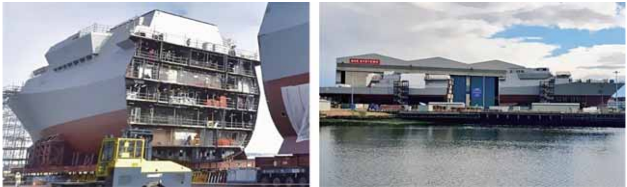
圖六：英國「26型」巡防艦正進行船段組裝作業
