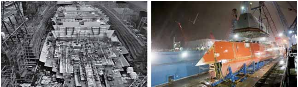
圖一：傳統方式造船(圖左)與模組化建造(圖右)
