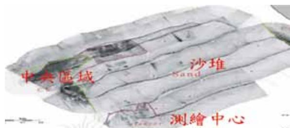
圖十：拖曳聲納描繪底層海床地貌影像
