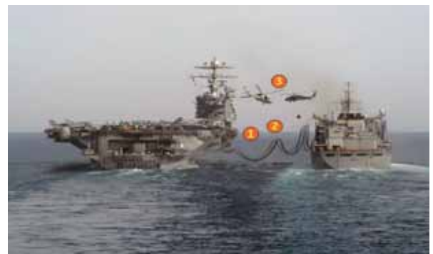
圖二：華盛頓號(CVN-73)航艦與供應級T-AOE-6同時實施三種整補
