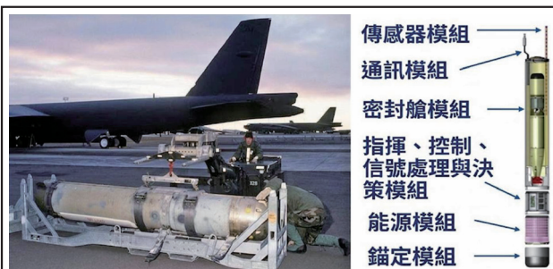
圖二：美軍「Mk-60」空投型水雷(圖左)與模組化設計之「錘頭鯊」水雷(圖右)
