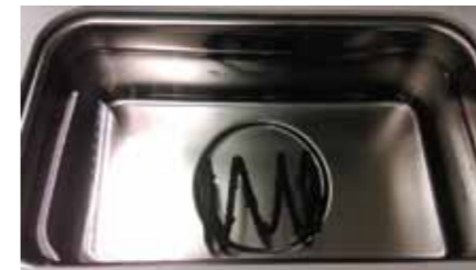
圖9 水密門彈簧置入清洗槽中示意圖
