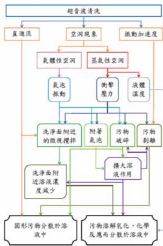
圖1 超音波洗淨原理示意圖
