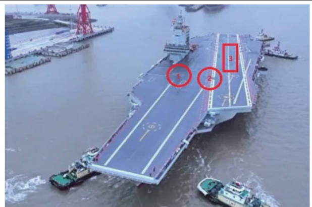
圖三：中共航艦「福建艦」(1、2為彈射器位置，3為降落跑道)
