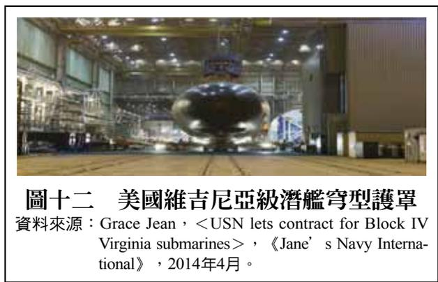
罩、潛艇帆罩、錐形尾罩、前端穹型護罩等，如美國維吉尼亞級潛艦採用複合纖維材料搭配環氧樹脂以真空注入法製作之前端穹型護罩，提供了良好的耐腐蝕、耐海水及良好
