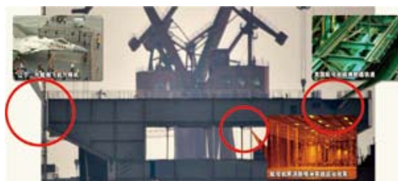
圖十 國產航母模擬分段細節分析，最令人驚訝的是為電磁彈射器準備的開槽結構
