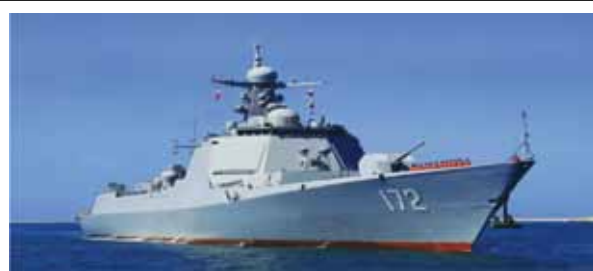
圖三：052D型驅逐艦首艦昆明艦，其相位陣列雷達天線外罩形狀趨平面
