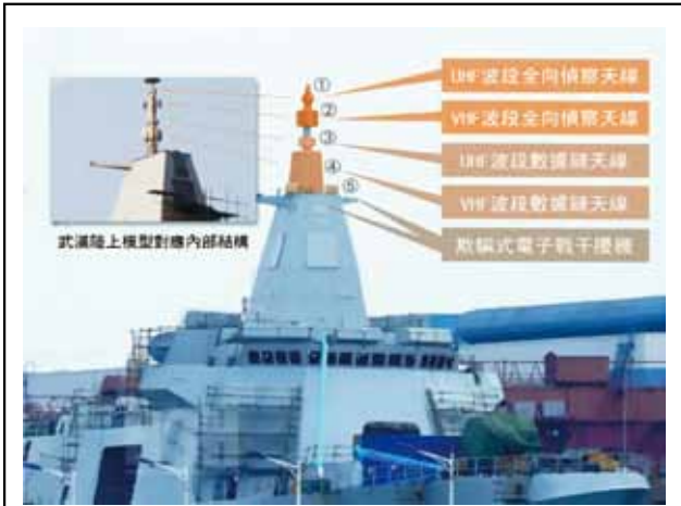
圖六：055型飛彈驅逐艦「艦載綜合射頻系統」採共用天線的一體化桅杆
