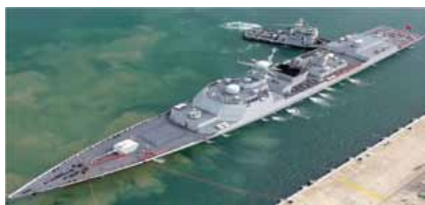
圖四：052D型驅逐艦的飛彈垂直發射系統改採通用型垂直發射單元，全艦共64個發射隔艙
