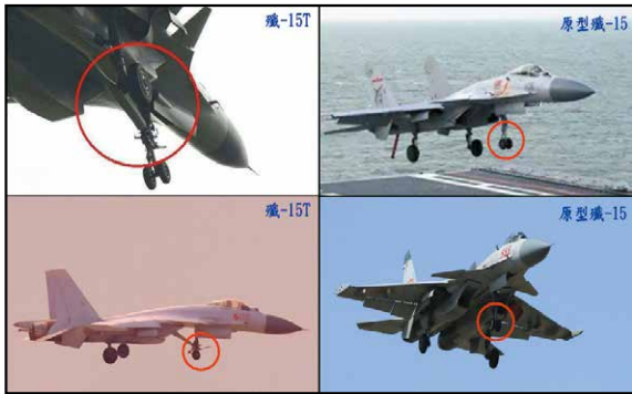
圖8：新舊殲-15型機起落架差異示意圖
