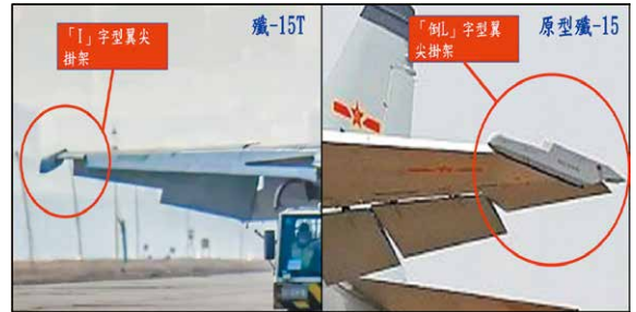
圖 12：新、舊殲-15機翼翼尖對照圖
