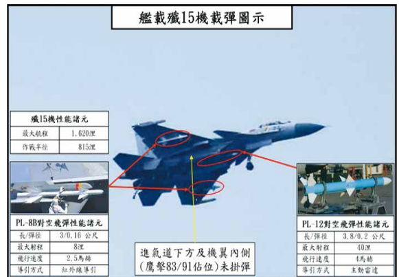
圖1：殲15型機武器掛載示意圖
