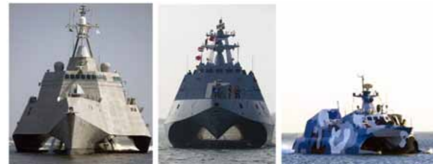
圖1 三體船結構之獨立號 2 圖2 雙體船結構之沱江艦 3 圖3 中共022級飛彈快艇 4
