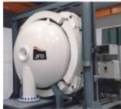
圖 2. 水壓艙測試系統
