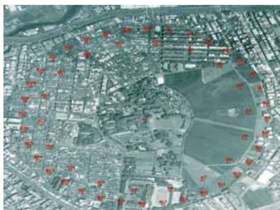
昔海軍鳳山電信所之通信副塔和繫固座墩，分為A圈及B圈兩圈；A圈共有18座副塔、直徑為680公尺；B圈共有36具座墩、直徑則為800公尺（載自高雄市政府文化局網站）
