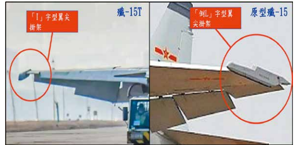
圖 12：新、舊殲-15機翼翼尖對照圖
