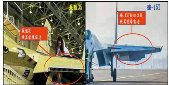
圖 11：蘇愷35與殲-15T型機機翼前緣雷達比照圖
