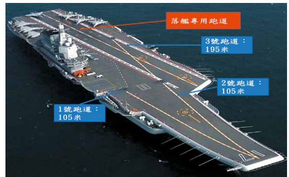
圖6：中共山東號航母飛行甲板跑道示意圖
