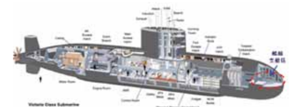
圖 18 加拿大 Victoria 級潛艦艦艙間示意圖
